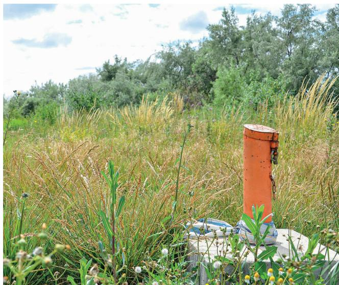
Exemple de piézomètre - appareil de mesure de la hauteur « piézométrique », c'est-à-dire le niveau d'eau de la nappe phréatique.
